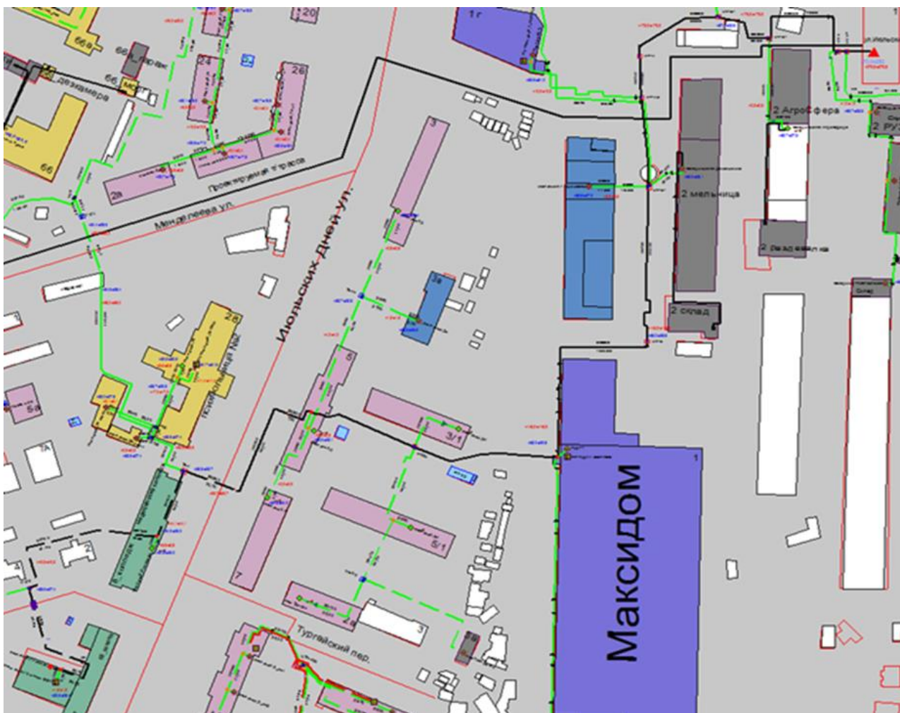
Рисунок 3.39 – Трассировка теплопровода от котельной АО «Теплоэнерго» по ул. Июльских дней, д. 1 до конечного потребителя «ПТ-Июль.дней, 10 школа»
