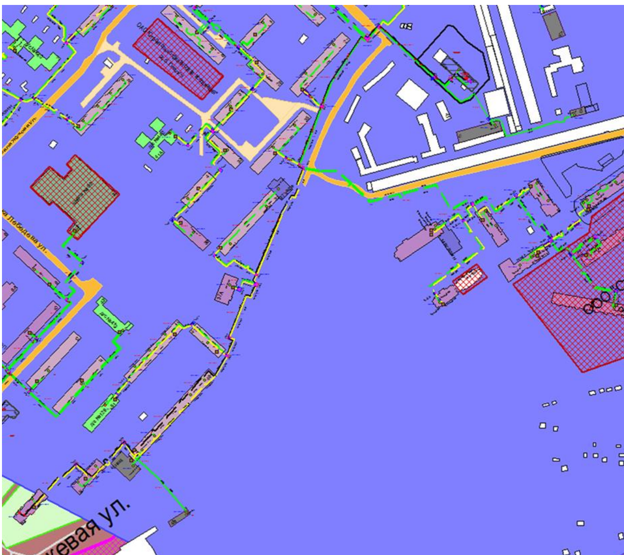
Рисунок 3.116 – Трассировка теплопровода от котельной АО «Теплоэнерго» «Вятская» по ул. Голованова, д. 25А до конечного потребителя «ПТ-Голован,57 э2»
